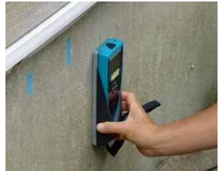
「基礎配筋」の調査機器
