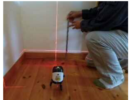
「床の傾きを計測する」調査機器
